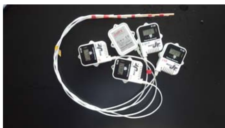
図8 5チャンネル仕様のセンサー部
