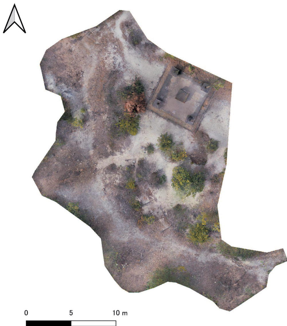
SfM測量の3次元モデルから生成したオルソ画像（平面図）
