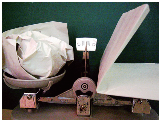
写真2 形の違いによる重さの比較の実験
